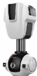
UP-300配电站巡检机器人
