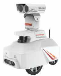
PIR-300变电站巡检机器人
